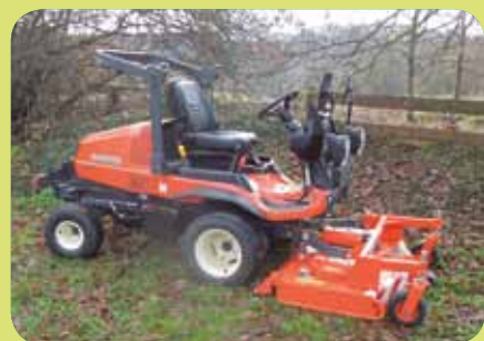
Ce type de matériel va optimiser le temps de nos agents : largeur de coupe plus importante, suppression du ramassage et paillis protecteur grâce au mulching, maniabilité...
